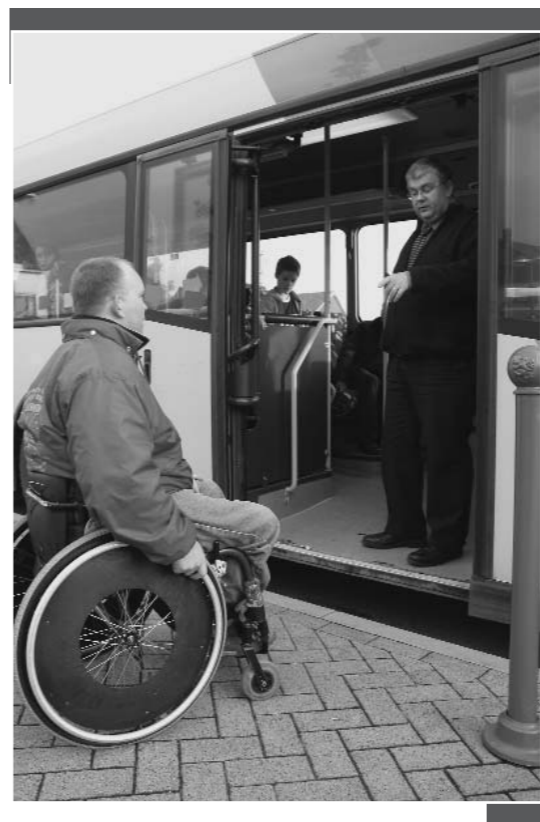
Ärgerlich: Die fehlende Abstimmung von Buseinstieg und Höhe der Haltestelle lässt Rollstuhlfahrer außen vor
